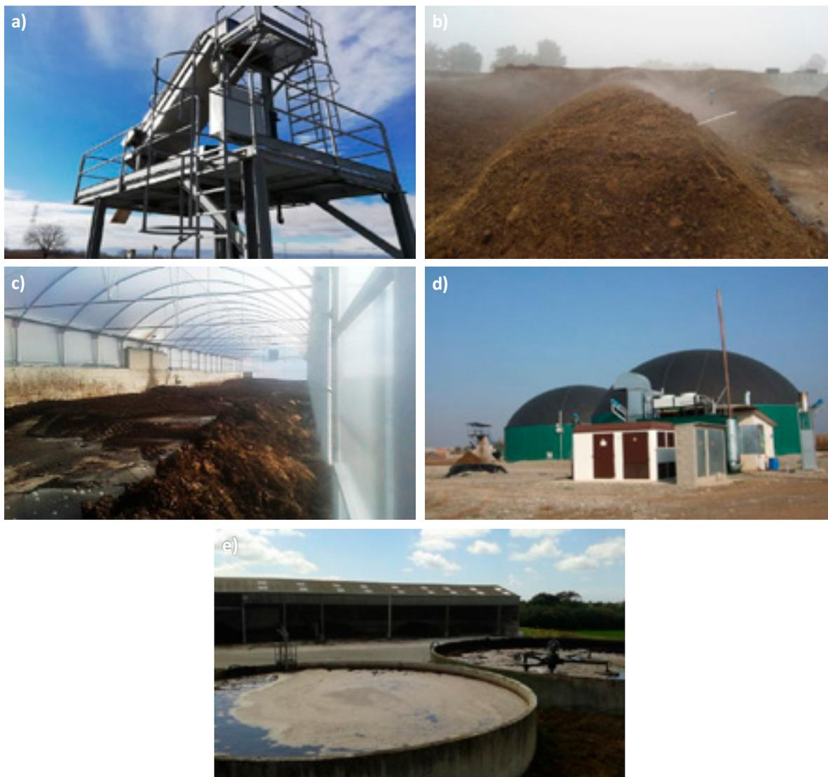
**Figura 4.2.** Tecnologías de tratamiento y valorización de las deyecciones ganaderas consideradas como consolidadas por parte del DARP: a) separación sólido-líquido de los purines; b) compostaje del estiércol y de fracciones sólidas de deyecciones; c) secado solar de purines, estiércol, y fracciones sólidas de deyecciones; d) digestión anaerobia de deyecciones; y e) nitrificación-desnitrificación de la fracción líquida de los purines.
