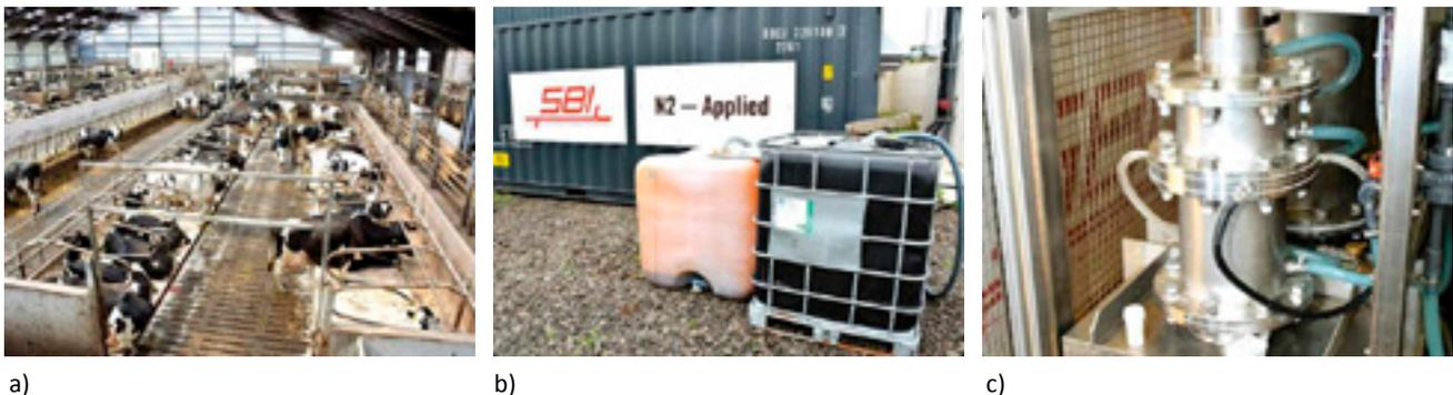
**Figura 5.2.** Implementación de una planta de producción de fertilizantes RENURE en una granja de producción lechera de Irlanda del Norte (Templepatrick) de 1200 vacas (a), por parte de la empresa noruega N2 – Applied (b), en un reactor de plasma basado en el proceso de Birkeland-Eyde (c). Fuente: The Farm Trader (<https://www.farmtrader.co.nz/features/1810/irish-farmer-trials-nitrogen-fixing-plasma-reactor>).
