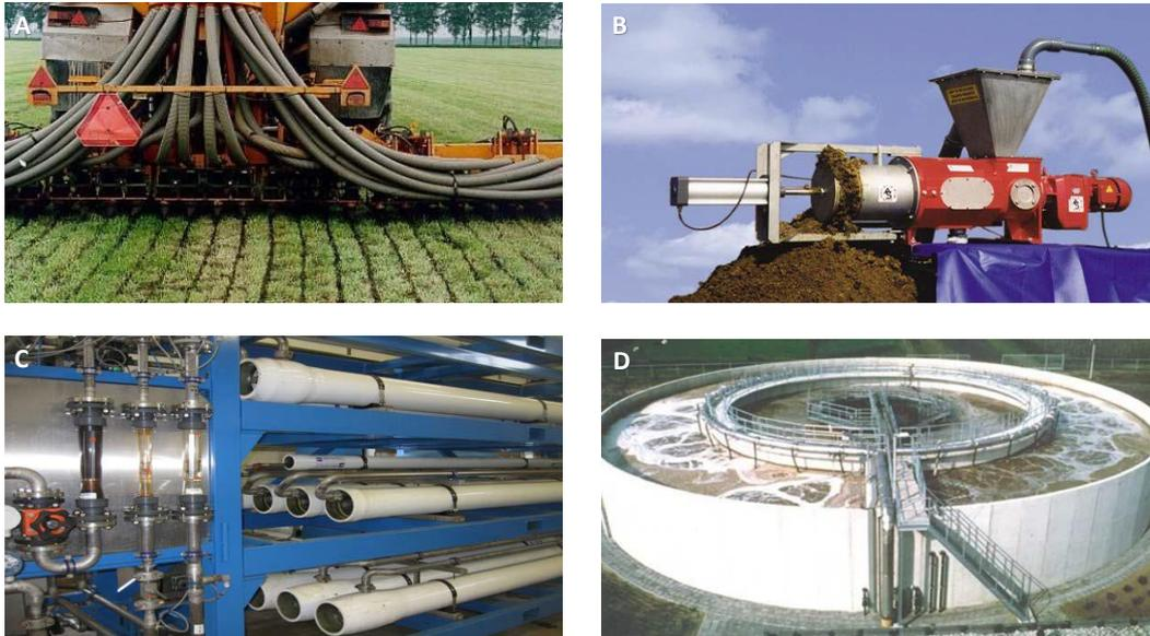
**Figura 3.** Sistemas de gestión y tratamiento de las deyecciones predominantes en los Países Bajos: (A) Aplicación agronómica del purín, fracción líquida, o digestato mediante inyección directa, (B) separación sólido/líquido, (C) ultrafiltración de la fracción líquida, y (D) tratamiento por nitrificación/desnitrificación de la fracción líquida (Jie et al. 2017).
